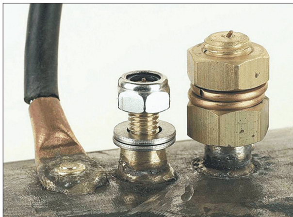
Рис. 3. Внешний вид при дуговой штифтовой пайке различными типами патронов
