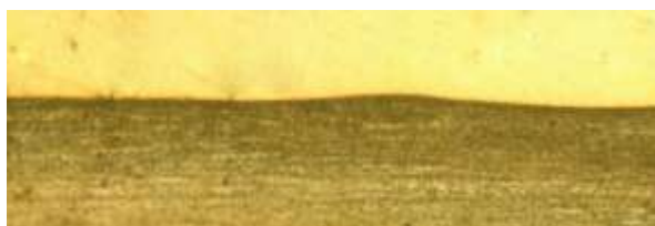
а) Линия проплавления паяного соединения в продольном направлении после травления 4% спиртовым раствором азотной кислоты
