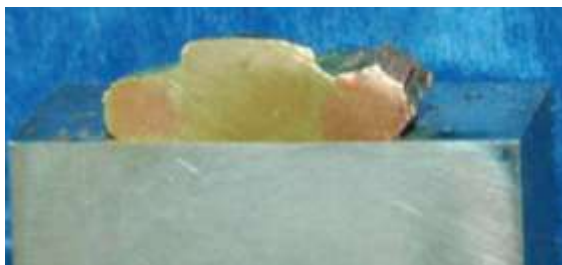
а) Макроструктура паяного соединения (продольный шлиф)
