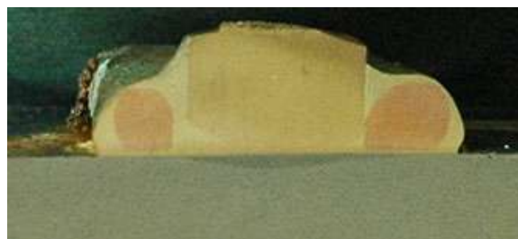
б) Макроструктура паяного соединения (поперечный шлиф)
