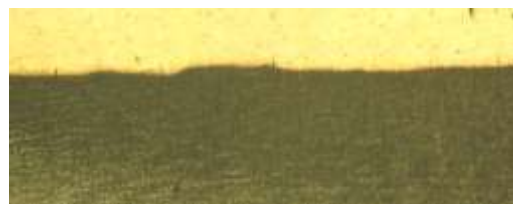
б) Линия проплавления паяного соединения в поперечном направлении после травления 4% спиртовым раствором азотной кислоты
