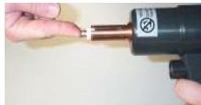
Если это удастся с трудом, попробуйте заменить патрон или держатель керамического изолятора. Если это не поможет, то, скорее всего пистолет неисправен и подлежит ремонту.
